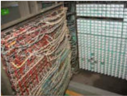
Panneau de petits relais 48volts et câblage de la tabulatrice BS150
